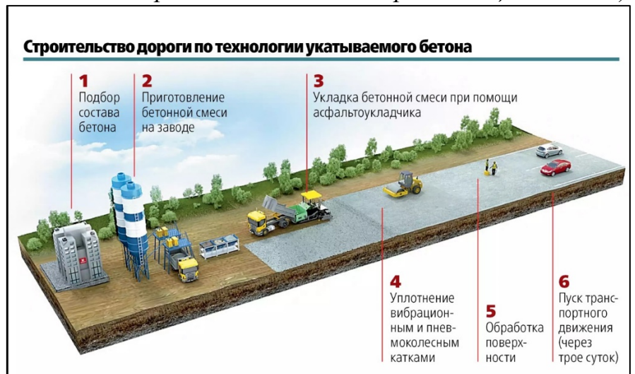
(Рис 4. Картинка «Строительство дороги по технологии при помощи бетона»)
