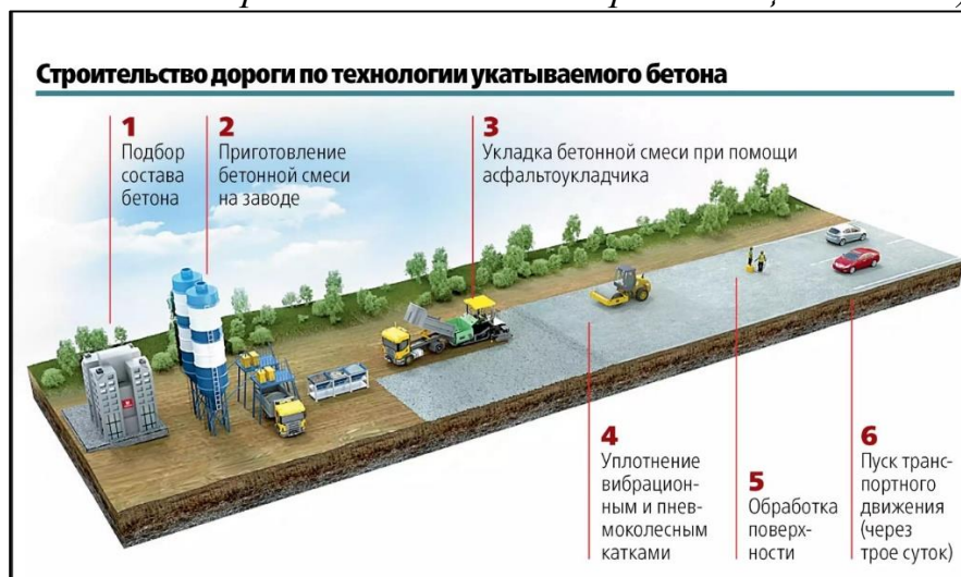
(Рис 4. Картинка «Строительство дороги по технологии при помощи бетона»)
